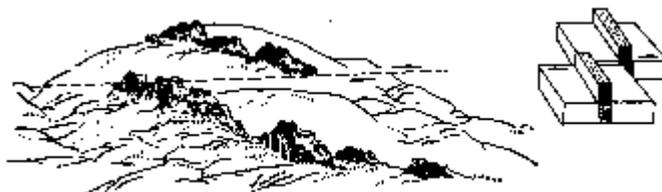
图2-30 由平推断层造成的岩层相对位移约20m（广东阳春）
