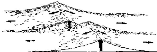
图2-35 发生于大洋中脊向的转换断层
