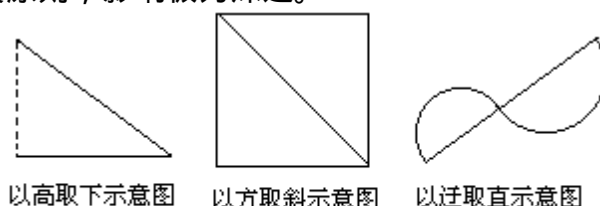
图6-12 裴秀的水平直线距离求算方法
