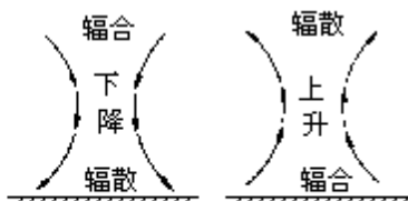
图4·6 水平气流的辐合、辐散和垂直运动的相互关系
