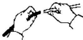
在玻璃管上套上橡皮管
