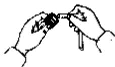
把玻璃管插入橡皮塞的孔里
