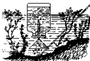
图 9-10 在池沼收集沼气示意图
