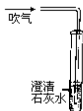
图8-4 用澄清石灰水 检验二氧化碳
