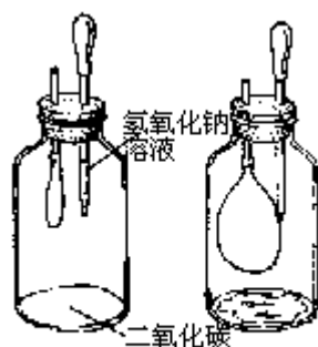
图9-14 氢氧化钠溶液跟二氧化碳的反应
