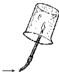
图7-10 液化气燃烧产生二氧化碳和水
