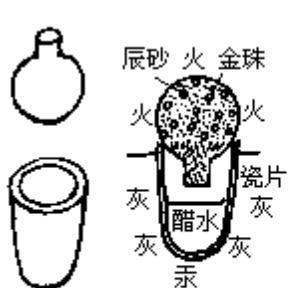
图5 石榴罐炼汞示意图
