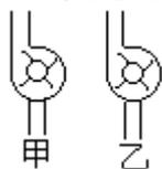
有的同学认为课本图 11—13 中离心泵叶片的方向画错了，应该改为图甲那样，实际上这种认识是错误的。离心泵是靠叶片高速旋转，水随着做离心运动，被向外甩并压入出水管的。叶片的方向如果像图甲那样，叶片兜水，不利于叶片旋转，对水的离心作用就小，因此是不对的。叶片方向应像图乙那样才对。
